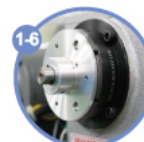
1-6 傳動使用電磁離合器 Transmission using electromagnetic clutch
